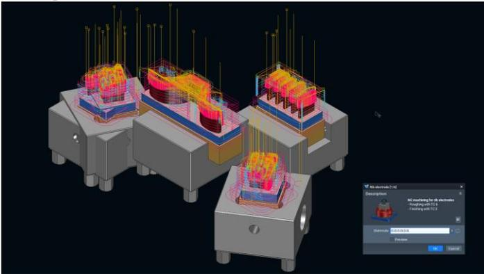
Un'applicazione perfetta per le lavorazioni in serie con SmartOps: progettazione e fresatura di elettrodi.
