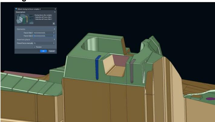
Un esempio pratico da Siebenwurst: gli SmartOps possono chiudere nervature di varie complessità in modo rapido e automatico.
