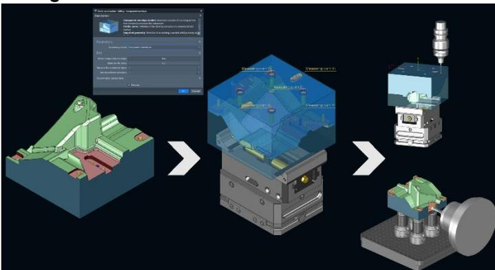
**La tecnologia SmartOps** guida l'utente CAD/CAM attraverso l'intero processo CAD/CAM—dall'importazione dei dati all'output NC. L'utente può accettare le impostazioni predefinite o modificarle interattivamente in ogni fase del processo.
