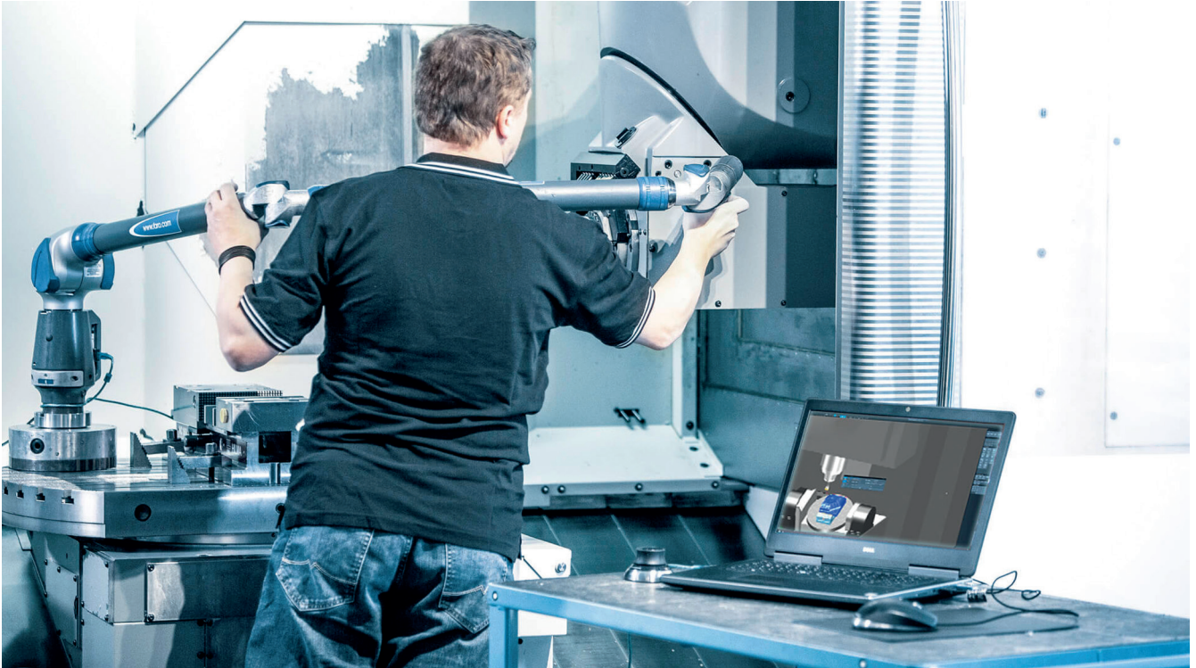
Bild 1: In Tebis wird die reale Bearbeitungssituation virtuell exakt dargestellt. Dazu werden alle Eigenschaften der Maschine präzise vermessen und in das CAM-System transferiert
