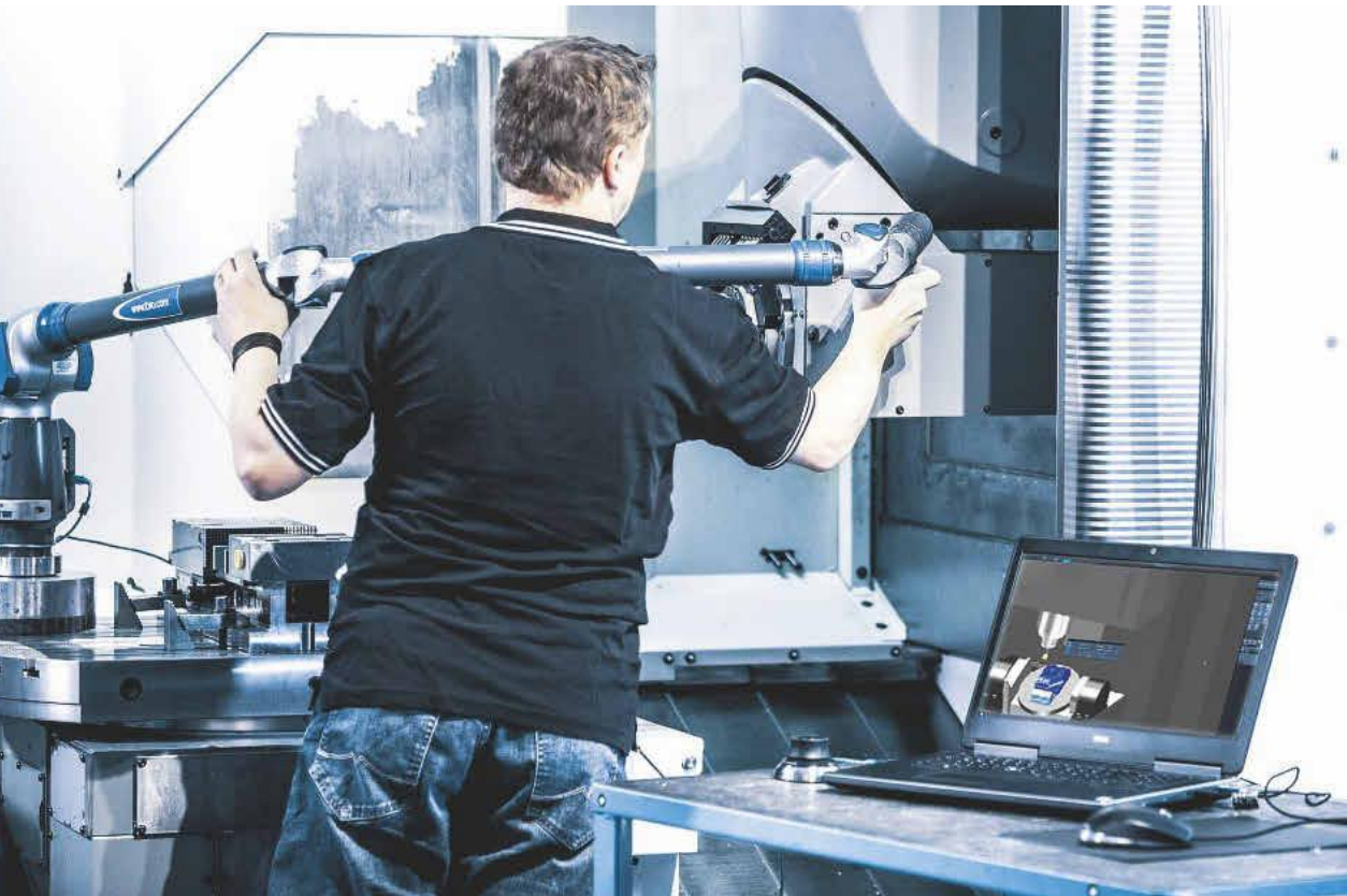
In Tebis wird die reale Bearbeitungssituation virtuell exakt dargestellt. Dazu werden alle Eigenschaften der Maschine präzise vermessen und in das CAM-System transferiert. Bild: Tebis AG
