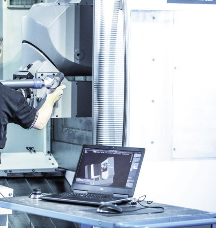
Lassen sich die einzelnen Aspekte der Bearbeitung – wie hier die Spannsituation – bereits bei der Arbeitsvorbereitung optimieren, dann sind Kollisionen effizient vermieden.
