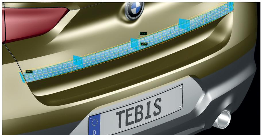
Bei der Flächenrückführung und der Flächenmodellierung bleiben in Tebis die theoretischen Kanten automatisch erhalten. In der Software stehen spezielle Funktionen zur Verfügung, um theoretische Kanten schnell zu erzeugen
