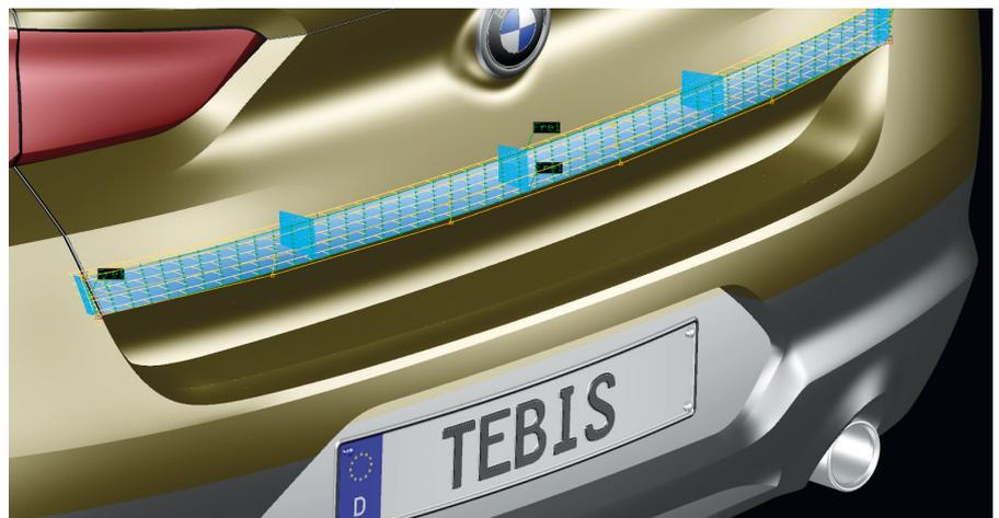
Con il reverse engineering e la modellazione delle superfici in Tebis i bordi teorici sono calcolati automaticamente. Il software mette a disposizione funzioni speciali per generare rapidamente i bordi teorici
